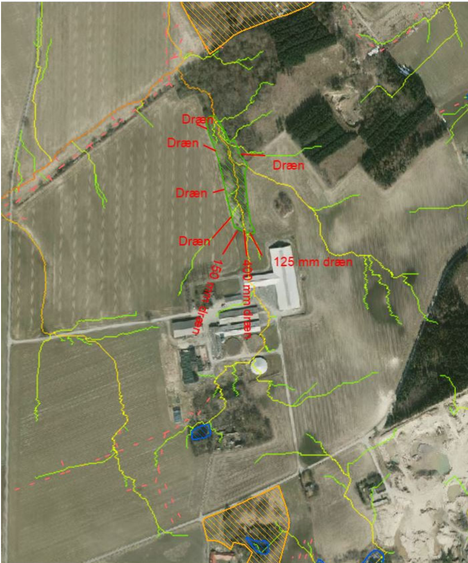
Figur 16 Dræn, som leder til engen nord for Ø. Pilegård. Drænene er indtegnet omtrentligt på baggrund af ejers oplysninger.
